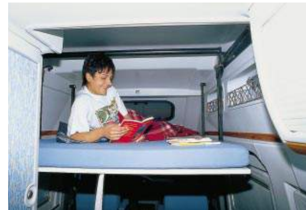
Bordkoje: Der Dachhimmel entpuppt sich als 198 x 125 Zentimeter großes Hubbett.
